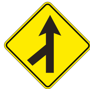
Incorporación de tránsito lateral P 22
